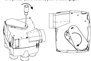
Réaliser le raccordement au moyen d'un câble électrique souple (4 x 1.5 mm²) passant dans une gaine de protection Ø20 mm. Engager la gaine dans le logement prévu et faire cheminer les fils dans le système d'arrêt de traction (chicanes). Il y a 2 possibilités en fonction du type d'interrupteur utilisé pour le changement de vitesse.
