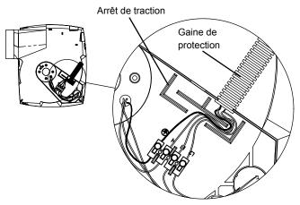
Dans le cas où les fils arrivent par 2 gaines (interrupteur et alimentation séparés), le boitier est doté d'une 2ème entrée ainsi que d'un 2ème système d'arrêt de traction.
