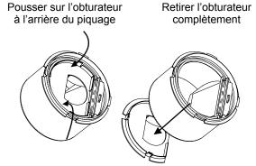
Attention : quelque soit le réglage réalisé, vérifier que le "volet 15-30" est bien en place en tirant légèrement jusqu'en butée.
